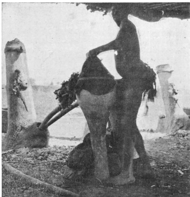
Fig. 4. — Soufflet à tambour des Lobi ; photo. Charles. Cf. Revue d'Ethnographie et de Sociologie , 1911, pl. XII.
